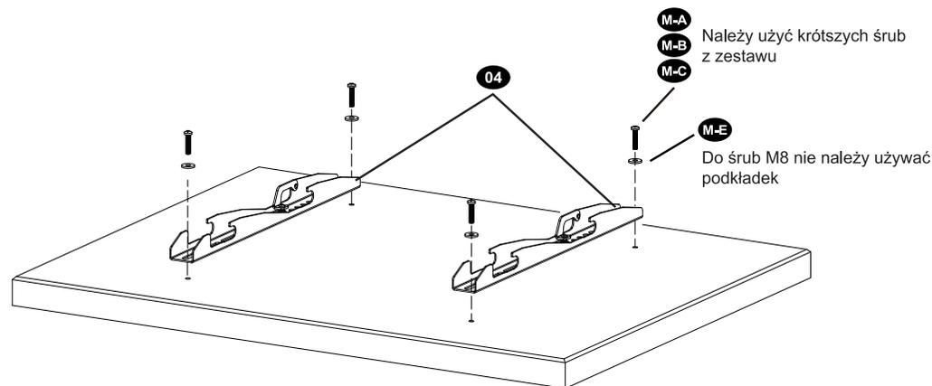
Mocowanie ramion do telewizora z zaokrągloną tylną obudową.
